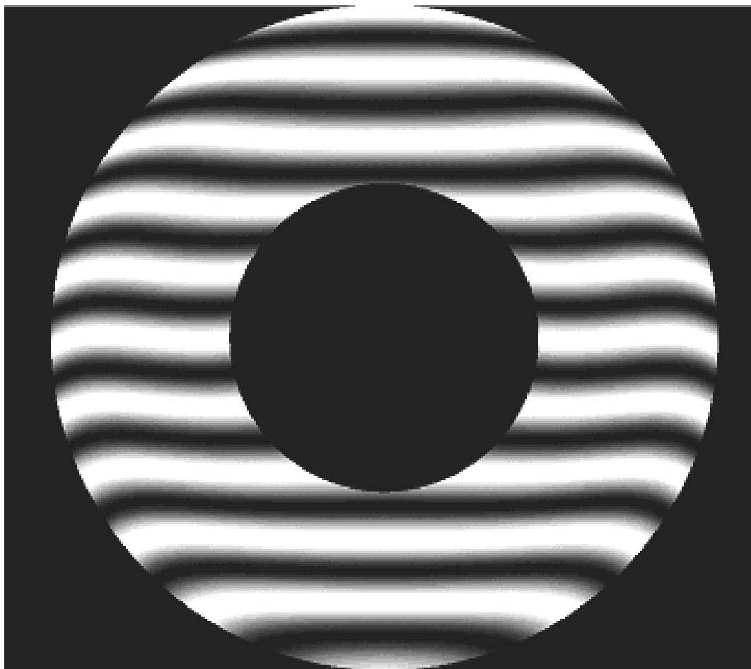
Рис.57. При использовании компенсатора полностью компенсируется сферическая aberrация 3 – го порядка исследуемого зеркала
