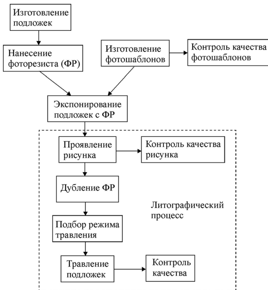
Рис. 4.7.1. Технологический процесс фотолитографии
