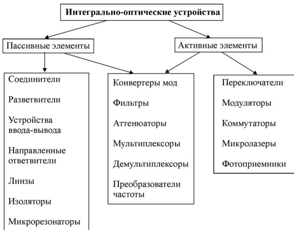
Рис.5.1. Составные части интегрально-оптических устройств
