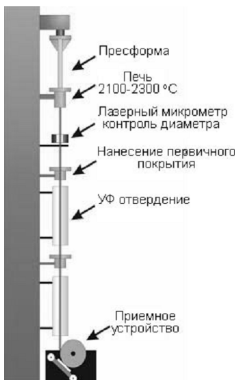
Рис.4.3.1. Установка вытяжки оптического волокна из преформы
