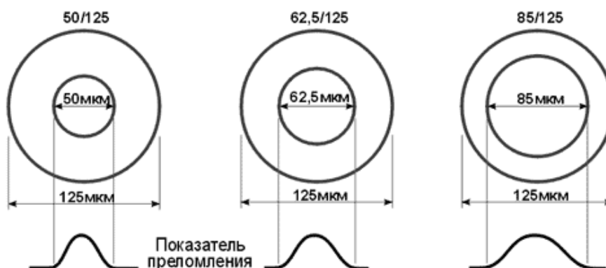
Рис. 2.2.2. Стандартное градиентное многомодовое волокно с диаметром сердцевины 50 мкм (а), 62,5 мкм (б) и 85 мкм (в)
