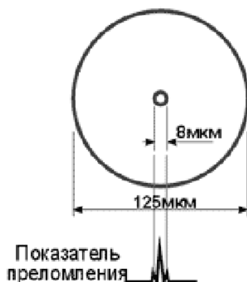
Рис. 2.2.4. Стандартное одномодовое волокно со смещенной дисперсией (DSF или NZDSF)
