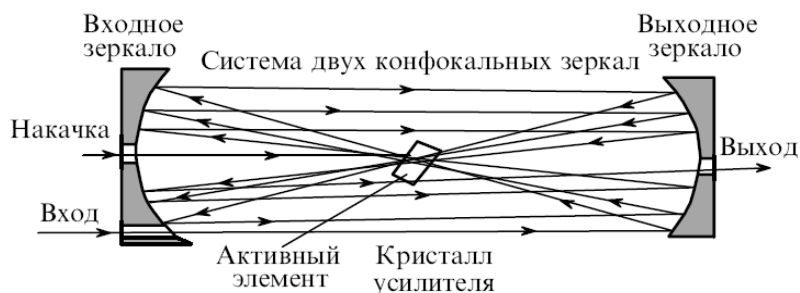
Рис. 1. Схема многопроходового усилителя.
