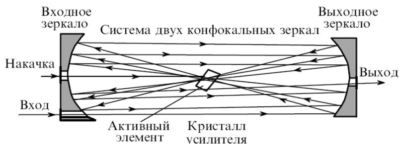
Рис. 1. Схема многопроходового усилителя.
