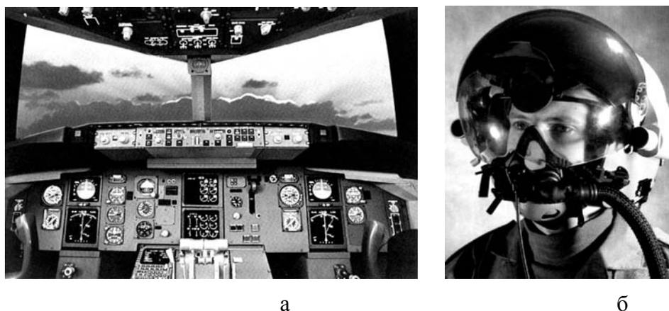
Рис.28. Применение дисплеев в авионике: а – тренажер для обучения летного состава (слева); б – нашлемный дисплей системы «Стракер» (справа) [3].
