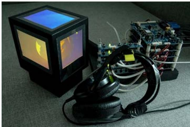
Рис.65. Пяти панельный кубический дисплей, отображающий 3D модель глобуса; также показано контрольное устройство и наушники с сенсором движений головы.
