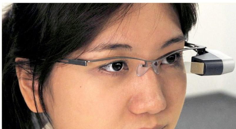
Рис. 75. Ретинальный дисплей, размещенный на оправе очков. Разработка фирмы Brothers Industries, LTD (Япония) [175].
