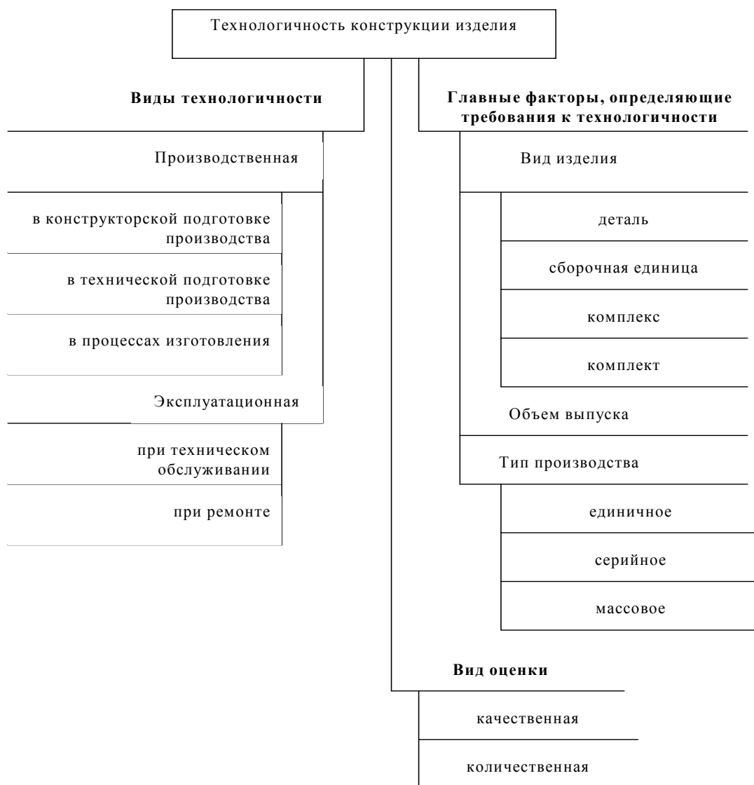
Рис. 6. Виды технологичности, факторы и способы оценки технологичности конструкции изделия
