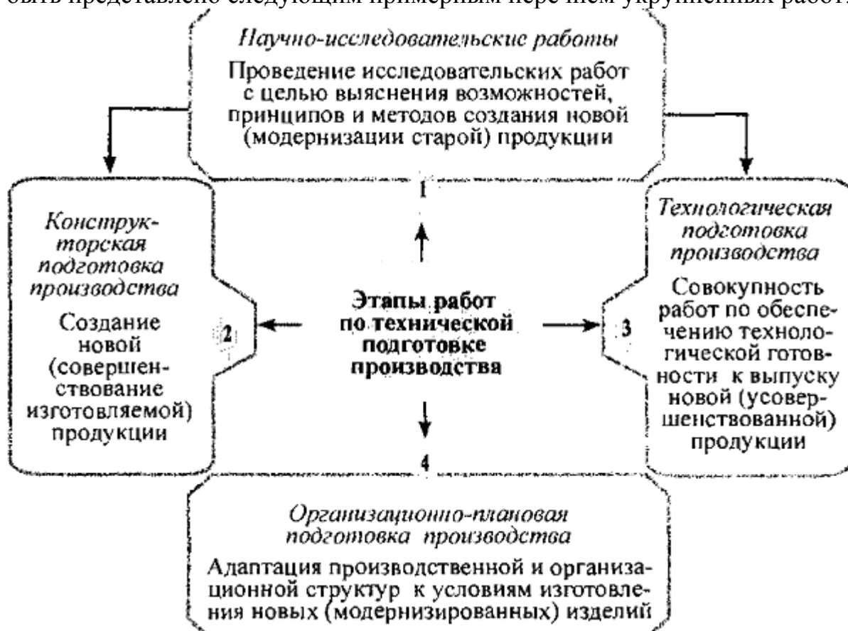
Рис. 1. Типовой состав работ по технической подготовке производства на предприятии
