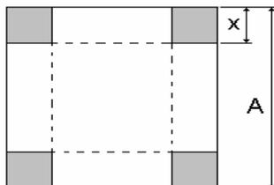
Рис.17. Схема разметки листа для изготовления коробки
