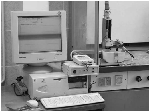
Рис. 8.7. Автоматизированная система контроля поверхностных напряжений механическим методом Меркулон «Тензор»
