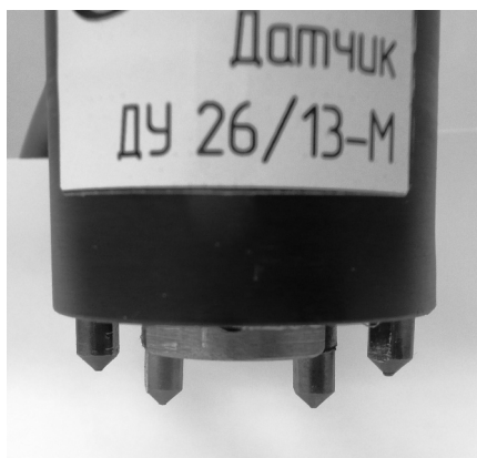
Рис. 10.8. Контакты датчика, внутренние контакты подпружинены.
