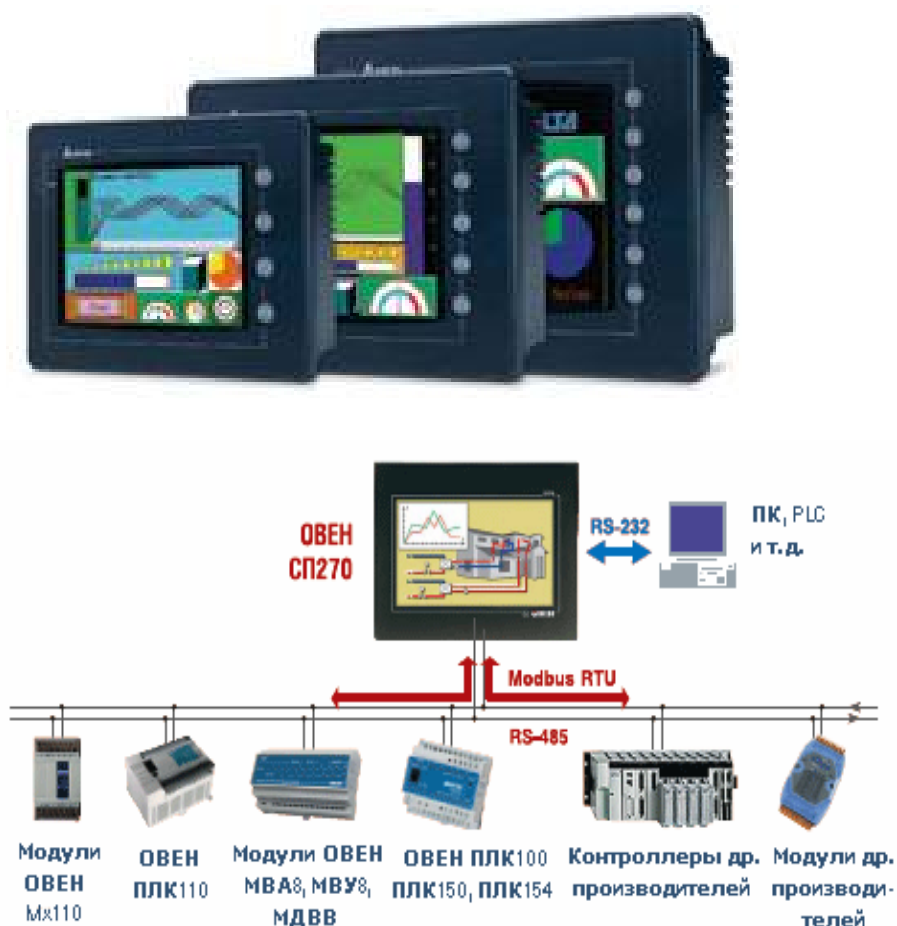
Рис.27. Схема панели оператора «Овен СП270» в промышленной сети
