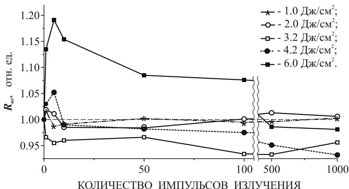
Рис. 1.2.5. Зависимость относительной отражающей способности эмали зуба человека ( R_{ae} ) от количества импульсов YAG:Er лазерного излучения, падающих в одну точку поверхности зубной эмали, при различных плотностях энергии лазерного излучения.
