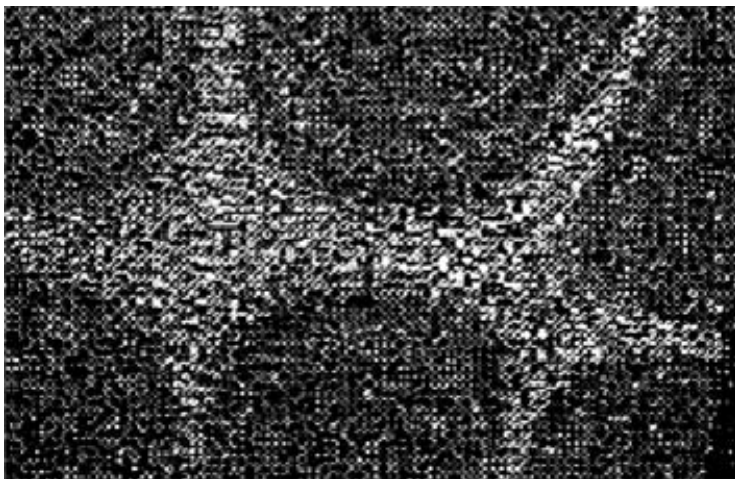
Рис. 8.37. Характерная картина спекл-интерферограммы
