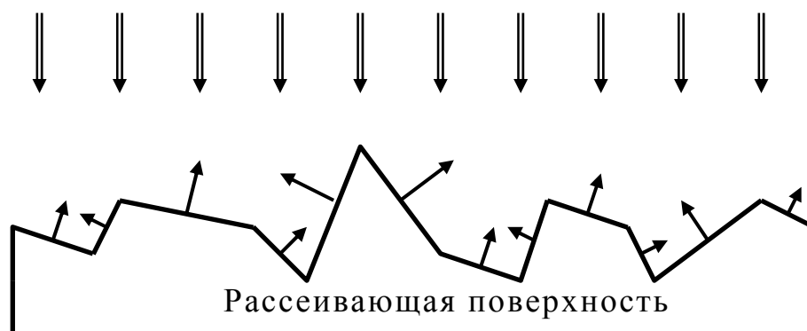
Рис. 8.2. Модель рассеяния на шероховатой поверхности
