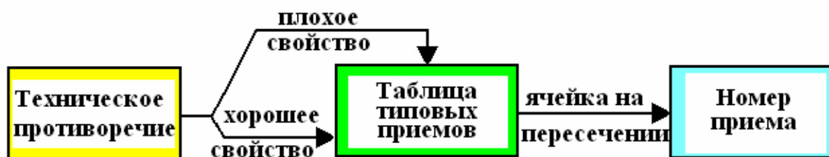
Рис.3.4. Процесс решения изобретательской задачи по таблице типовых приемов разрешения ТП
