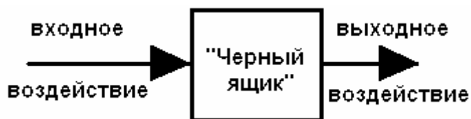
Рис. 1.9. Структурная схема системы в виде «черного ящика»
