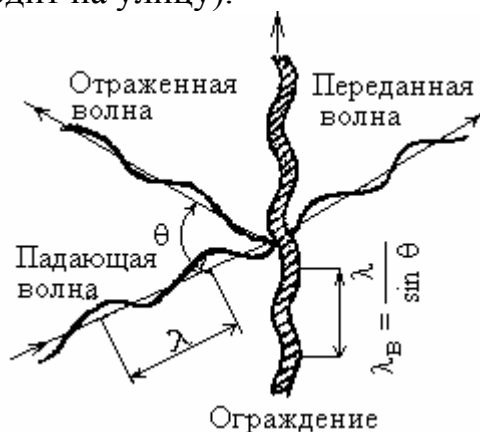
Рис. 15. Схема волнового совпадения
