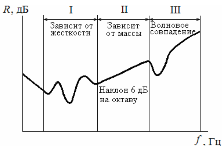
Рис. 14. Частотные диапазоны звукоизоляции однослойного ограждения
