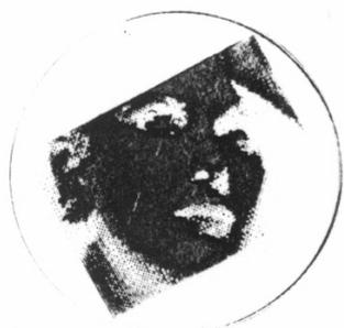
Изображение, полученное путем осаждения хрома на подложку стекла ( $N_2$ -лазер, метод LIFT, сканирующая техника).
