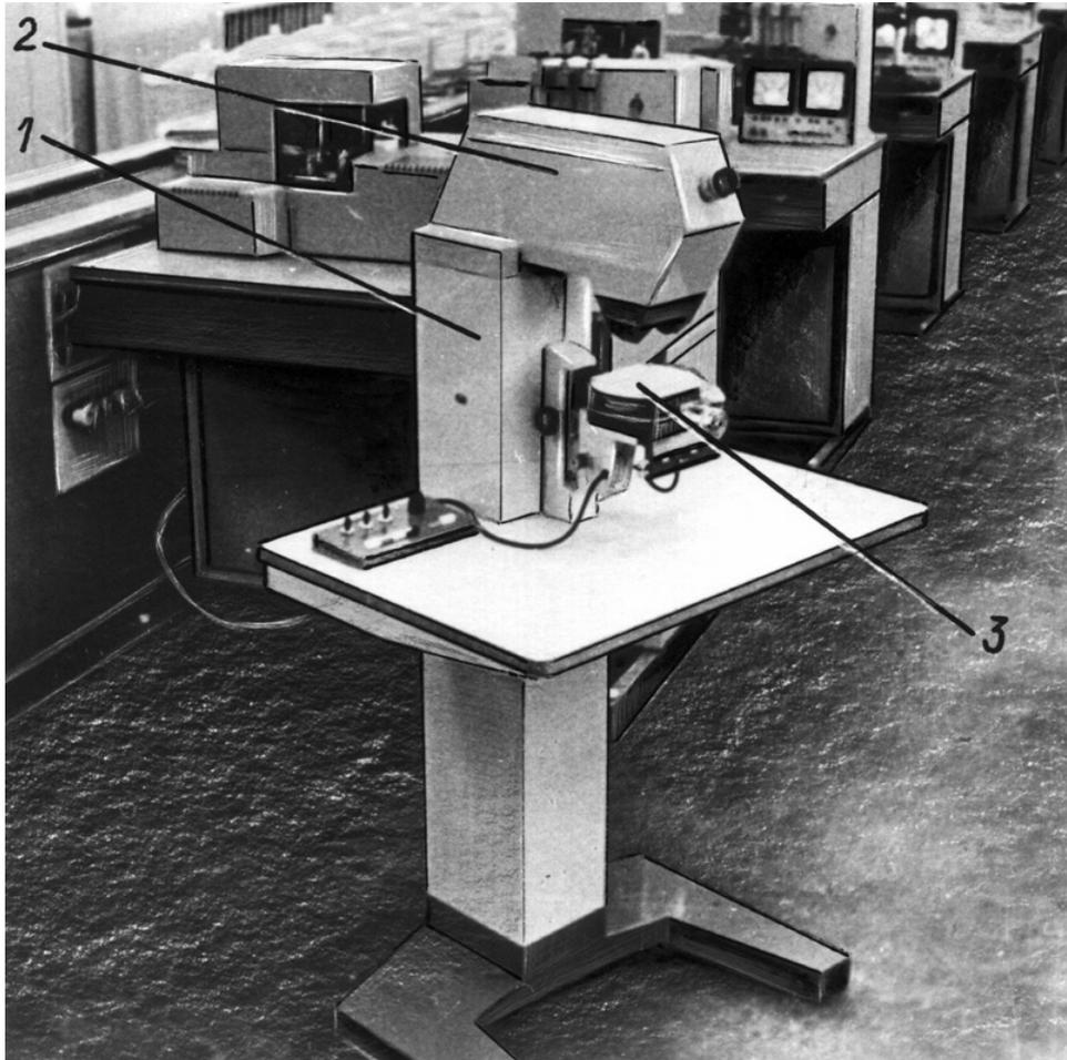
Лазерная установка “Кварц–2” (ИТМО) для оперативной корректировки топологии, ретуши фотошаблонов и подстройки параметров электронных компонентов в цеху предприятия
