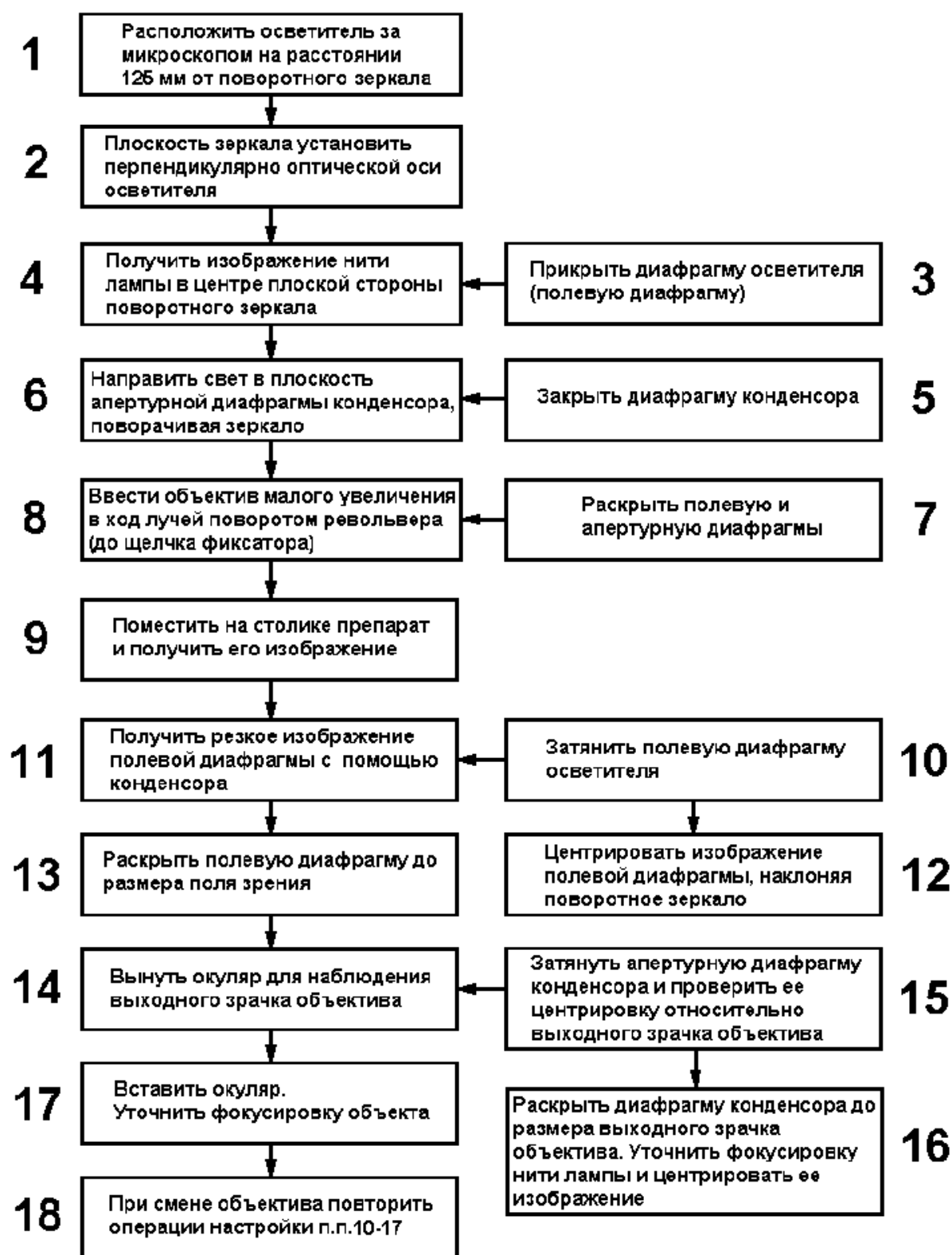
Рис. 6.6. Порядок операций настройки микроскопа при работе в проходящем свете. Освещение объекта по методу Кёлера.
