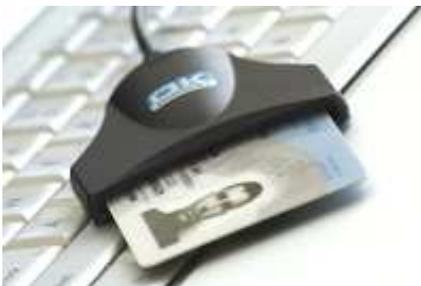
Рис. 13. ID-карта в считывающем устройстве
