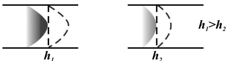
Рис. 27. Зависимость h от кривизны фронта кристаллизации
