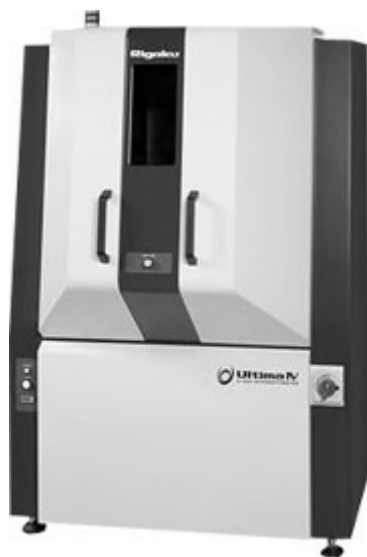
Рис. 1.5.23. Универсальный дифрактометр Rigaku Ultima IV, установленный в НИИ Оптикоинформатика
