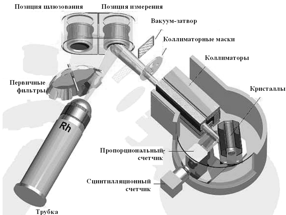
Рис. 1.5.20.Схема спектрометра SRS 3X00 и его компоненты.
