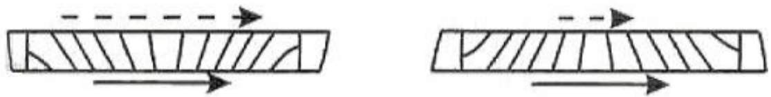
Рис. 1.2.10. Схема действия шлифа зуба в качестве фокона(увеличение-уменьшение).
