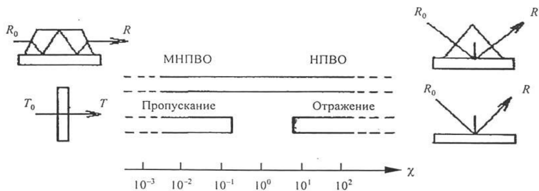
Рис. 2.2.9. Схема применения различных спектральных методов в зависимости от показателя поглощения исследуемого вещества.
