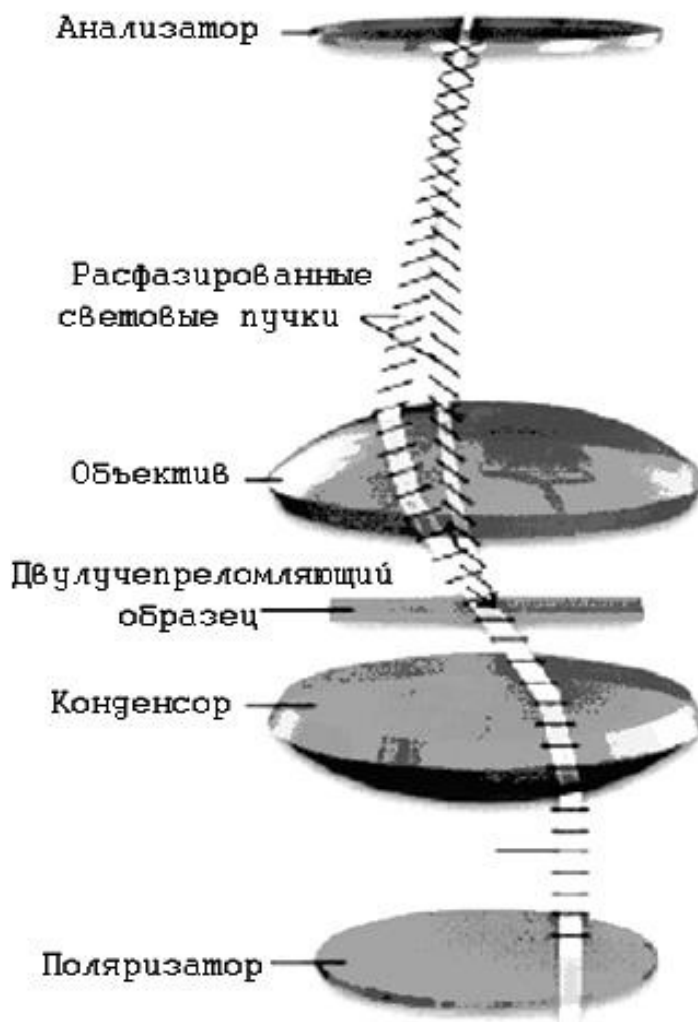
Рис. 1.2.5. Схема оптической части поляризационного микроскопа для наблюдения двухлучепреломления со скрещенными поляризаторами.
