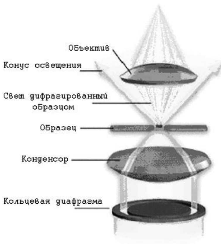
Рис. 1.2.2. Схема оптической части микроскопа темного поля
