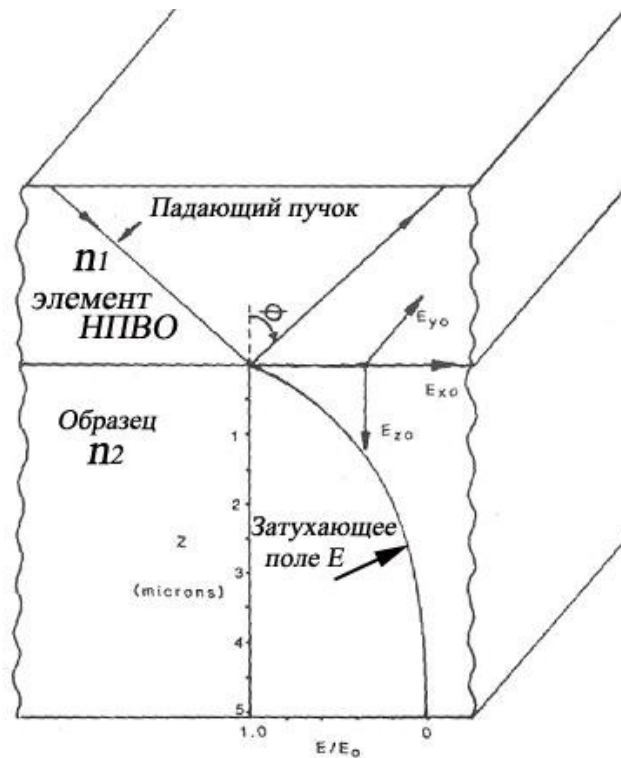
Рис. 2.2.4. Схема метода НПВО.
