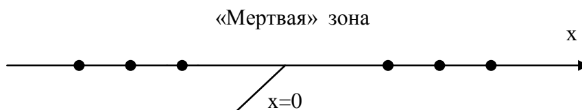
Рис. 7.6. Равномерный квантователь с «мертвой» зоной
