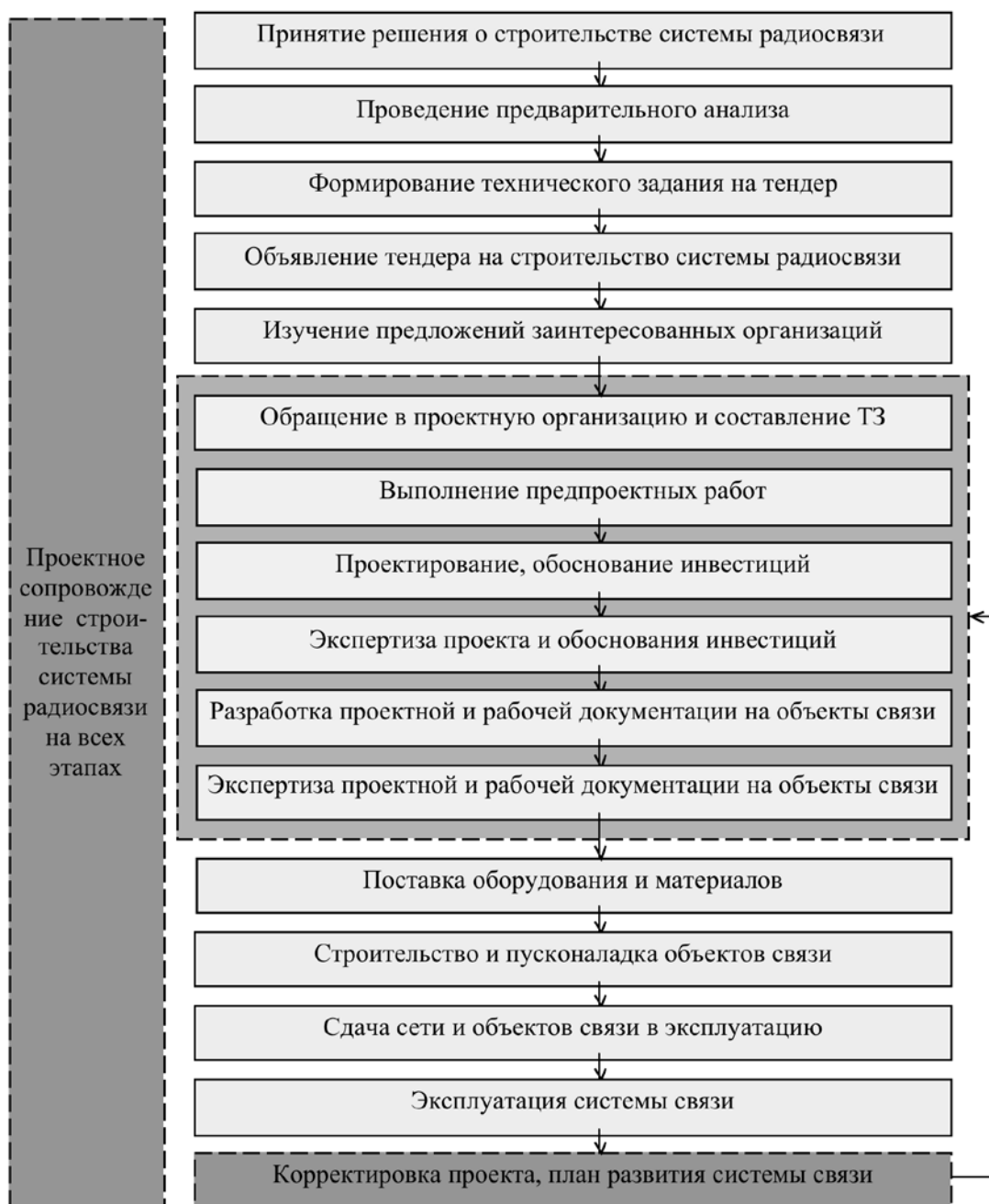
Рис. 3.1. Этапы проектного сопровождения строительства систем радиосвязи
