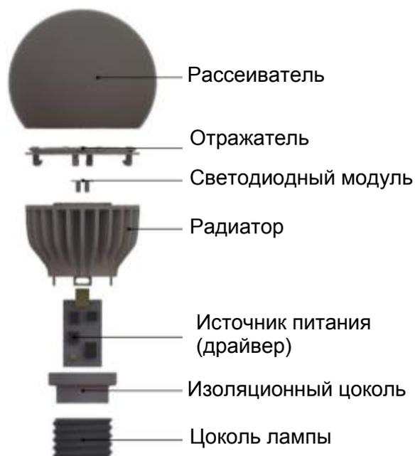
Рис. 64. Основные компоненты светодиодной лампы.
