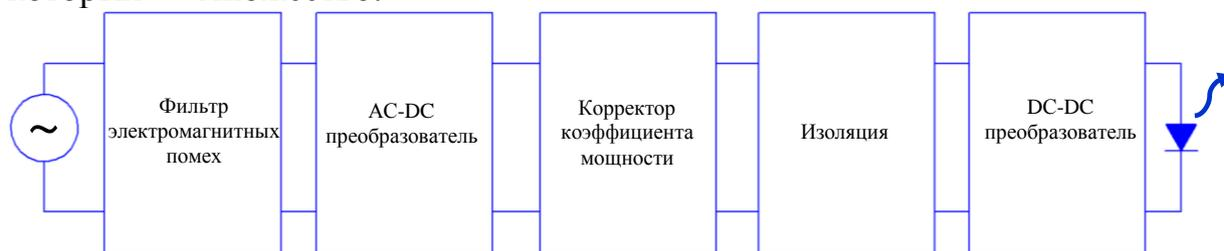
Рис. 114. Функциональная диаграмма устройства питания светодиодного источника света.
