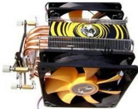
Рис. 103. Активный радиатор для охлаждения высокомоощных светодиодных источников.
