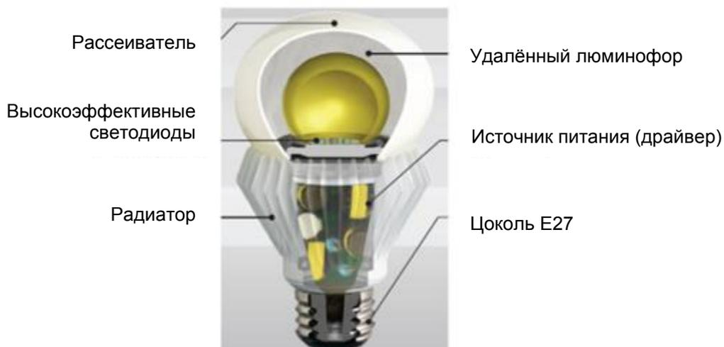
Рис. 66. Устройство светодиодной лампы производства компании Cree, в которой использована технология удаленного люминофора.
