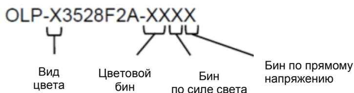
Рис. 31. Один из вариантов маркировки светодиода: первые буквы чаще всего уникальны и обозначают компанию-производителя, последующие символы — код продукта и его характеристик.
