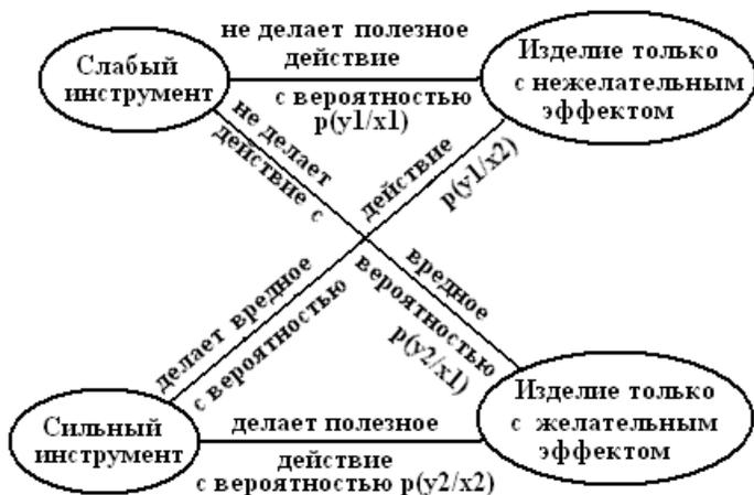
**Рис. 4.2.** Структурная схема технического противоречия
