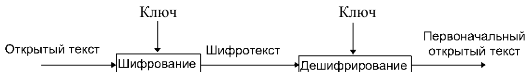
Рис. 1-2. Шифрование и дешифрование с ключом
