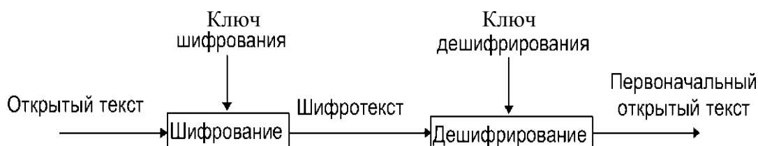
Рис. 1-3. Шифрование и дешифрование с двумя различными ключами
