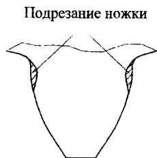
Рис. 8. Подрезание ножки зуба
