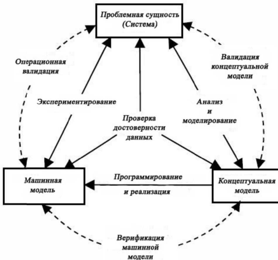
Рис. 1.4. Упрощенная схема процесса распределенного моделирования
