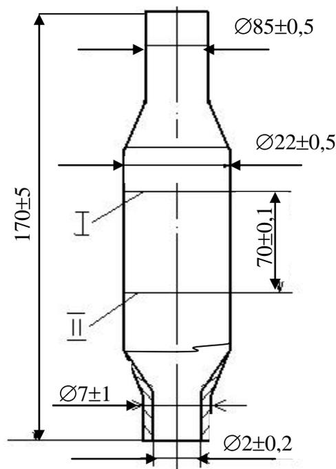
Рис. 13.2. Пипетка для определения отстаивания жира
