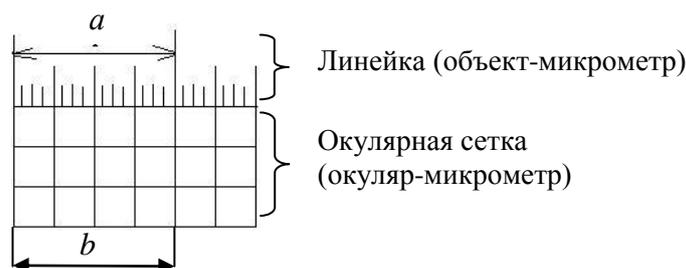
Рис. 1.1. Определение цены деления окуляр-микрометра
