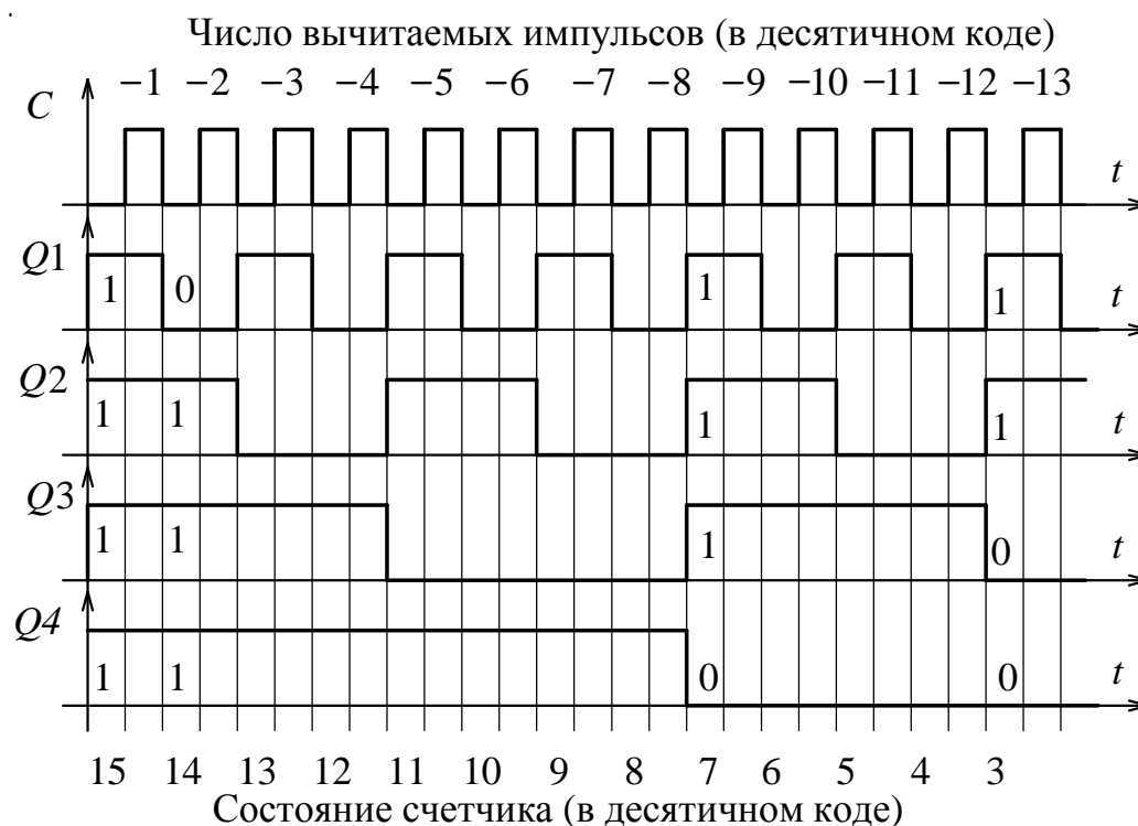
Рис. 8.4. Временные диаграммы в вычитающем двоичном счетчике с последовательным переносом
