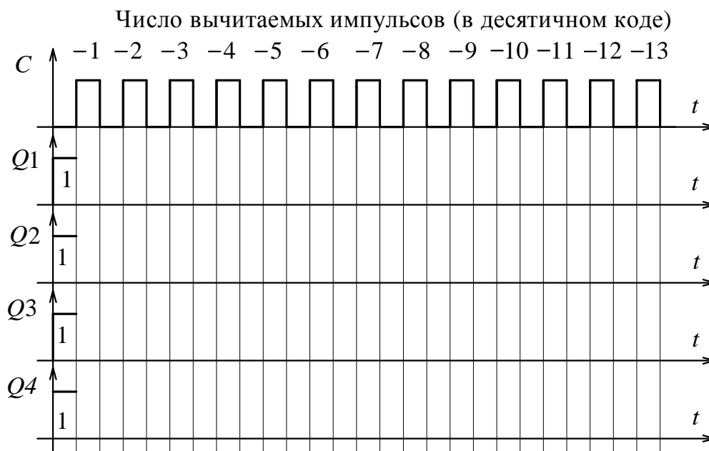
Рис. 8.10. Экспериментальные временные диаграммы в двоичном вычитающем счетчике с последовательным переносом
