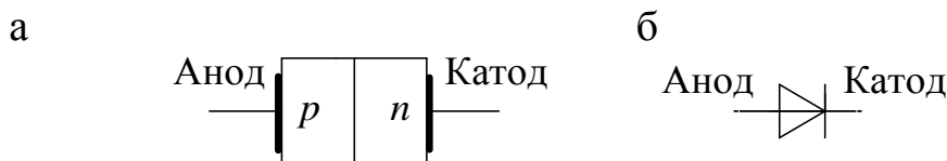
Рис. 1.1. Полупроводниковый диод: а – структура диода; б – условное графическое обозначение диода
