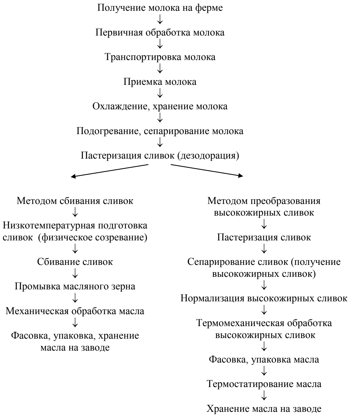
Рис. 1.1. Операционно-технологическая схема производства сладкосливочного масла
