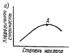
Рис. 115. Типовой график зависимости коррозионной стойкости от наклепа при обкатывании и вибронакатывании (а); график зависимости коррозионной стойкости (б): 1 — точение; 2 — вибронакатывание ( P = 600 Н); 3 — вибронакатывание ( P = 100 Н); 4 — шлифование; 5 — обкатывание ( P = 600 Н)
