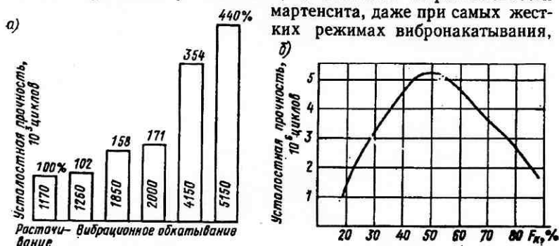
Рис. 114. Зависимость усталостной прочности вкладышей от способа обработки и вида регулярного микрорельефа (а) и от площади F_n (б), занимаемой вибронакатанными канавками
