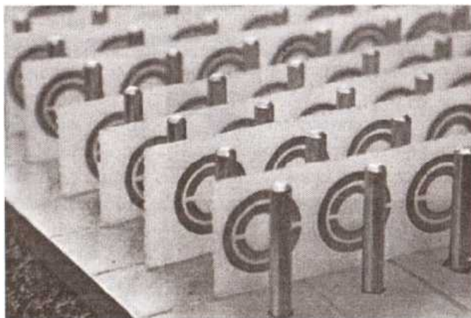
Рис. 2.6. Искусственная периодическая среда, позволяющая получить эффект отрицательного преломления
