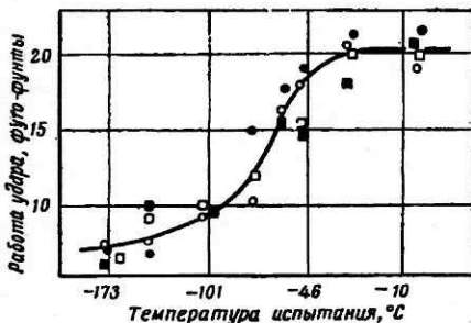
Рис. 192. Ударная вязкость хромоникельмолибденовых сталей с 0,29% С при низких температурах на поперечных образцах. Стали закалены и отпущены при 600^{\circ}\text{C} ; \sigma_b = 133 \text{ кг/мм}^2
