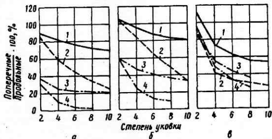
Рис. 188. Влияние степени уковки и ликвации на коэффициент анизотропности механических свойств: а — относительное сужение; б — относительное удлинение; в — ударная вязкость; 1 — без заметной ликвации (электросталь); 2 — то же, (марте- новская сталь); 3 — развитая ликвация; 4 — очень развитая лик- вация
