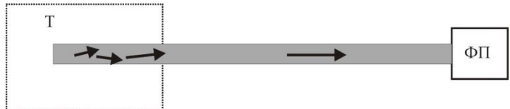
Рис. 6.2.2. Волоконно-оптический датчик для измерения температуры на основе генерации излучения в волокне.
