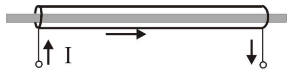
Рис.6.2.5. Чувствительный элемент волоконно-оптического датчика для измерения силы тока на основе термооптического эффекта.
