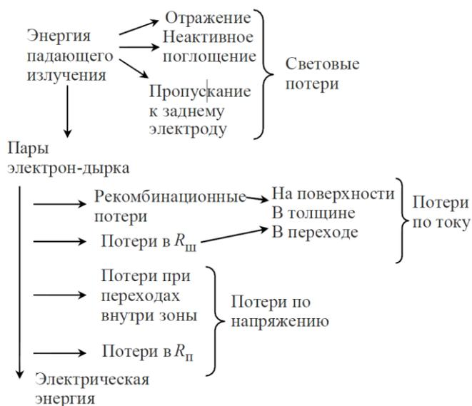
Рис. 2.2. Потери энергии в солнечном элементе:  $R_{ш}$  — шунтирующее сопротивление;  $R_{п}$  — последовательное сопротивление
