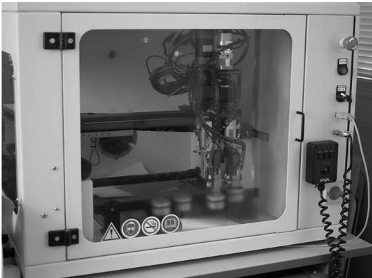
Рисунок 5.5: Настольная система дозирования, нанесения влагозащитного покрытия или компаунда PVA 350 [24].
