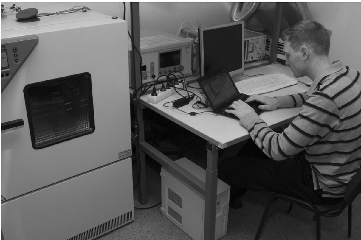
Рисунок 5.4: Климатическая камера BINDER [24].
