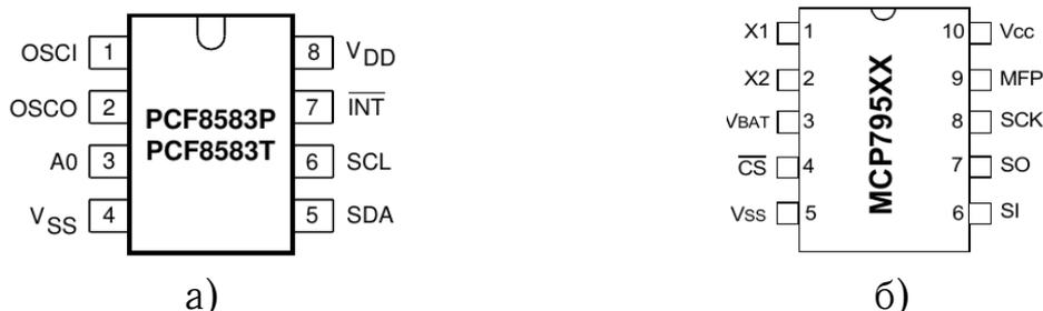
Рисунок 4.2: а) часы реального времени PCF8583 с интерфейсом I<sup>2</sup>C, б) часы реального времени MCP795 с интерфейсом SPI.
