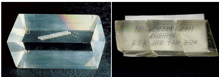
Рисунок 1.3 – Явление двулучепреломления в кристалле исландского шпата
