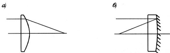
Рис. 48. Плоскопреломляющая (а) и плоскозеркальная (б) линзы
