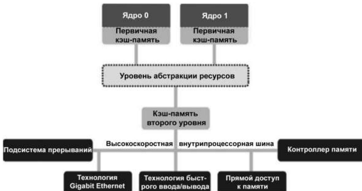
Рис. 15. Структура типового многоядерного процессора [20].
