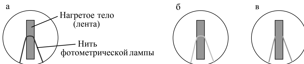
Рис. 2. Измерение температуры яркостным пирометром: а – яркость нити лампы меньше яркости тела; б – яркость нити лампы больше яркости тела; в – яркости нити лампы и тела равны
