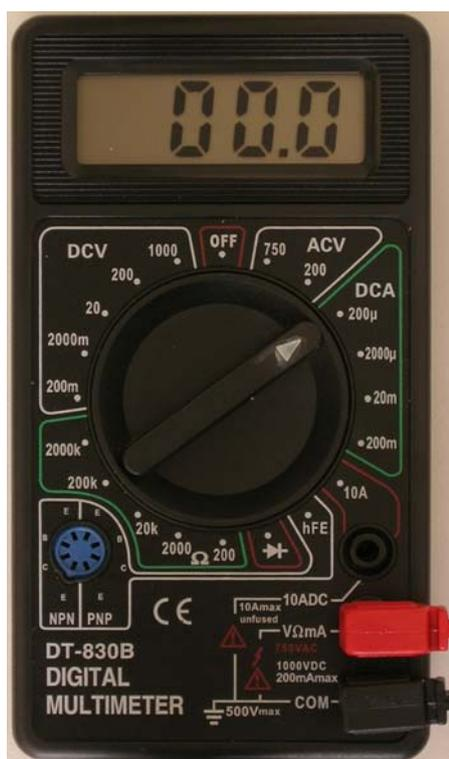
Рис. 3. Цифровой мультиметр, включенный на предел измерения 200 мкА
