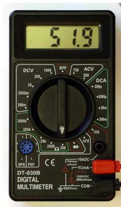
Рис. 2. Цифровой мультиметр, включенный на предел измерения 200 Ом
