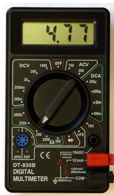
Рис. 3. Цифровой мультиметр, включенный на предел измерения 20 кОм
