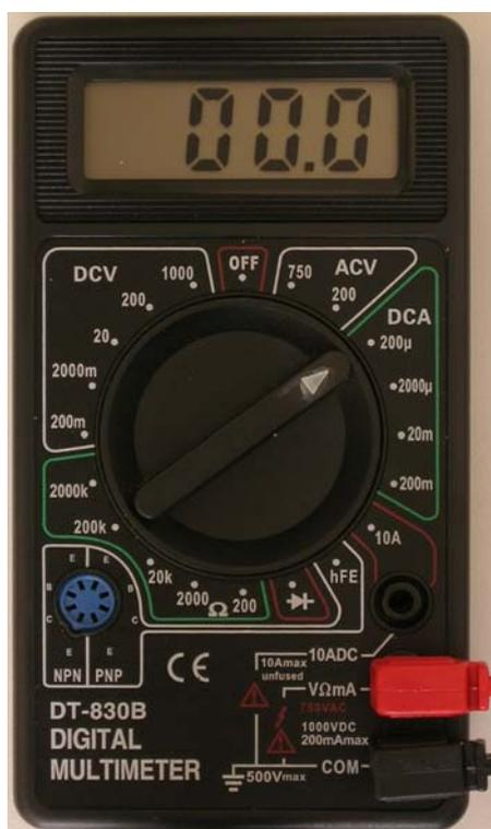
Рис. 4. Цифровой мультиметр, включенный на предел измерения 200 мкА
