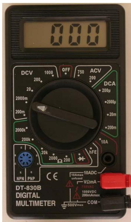
Рис. 3. Цифровой мультиметр, включенный на предел измерения 2000 мВ
