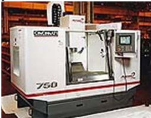
Рисунок 3.12 - Вертикальный обрабатывающий центр серии «ARROW-2», модели 750
