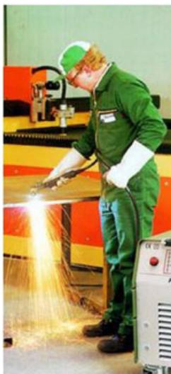
Рисунок 3.61 - Ручная плазменная обработка
