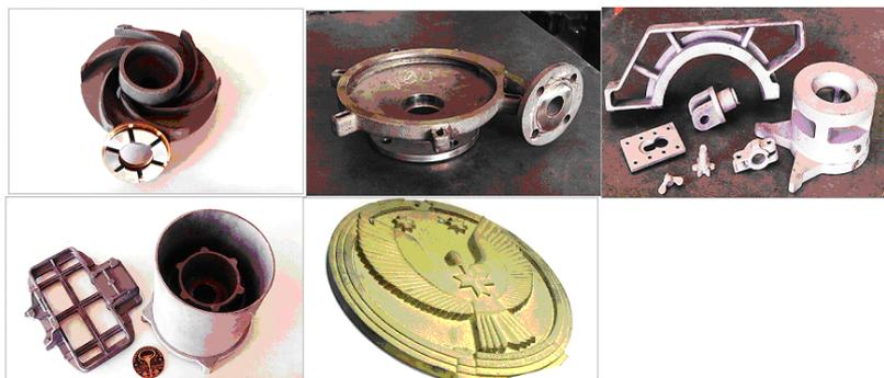
Рисунок 2.6- Образцы отливок, полученных литьем по выплавляемым моделям
