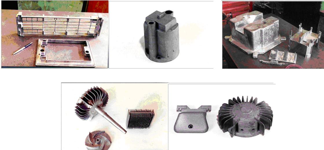
Рисунок 2.11- Образцы отливок, полученных литьем под давлением
