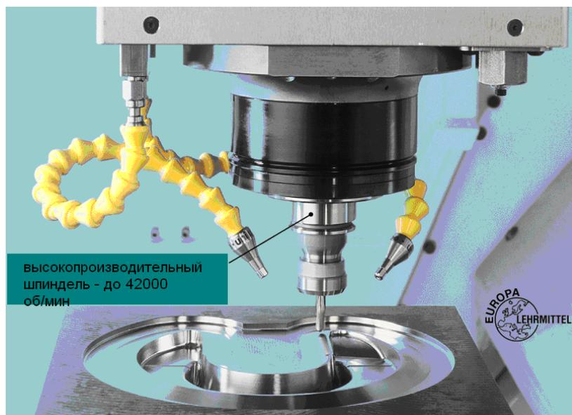
Рисунок 3.26 - Процесс фрезерования концевой фрезой сложной поверхности
