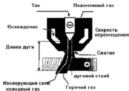
Рисунок 3.63 - Схема плазменной обработки
