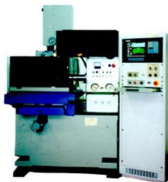
Рисунок 3.51 - Электроэрозионный 5-ти координатный проволочный вырезной станок с ЧПУ мод. СКЭ250Ф5
