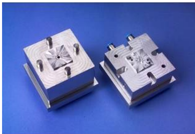
Рис. 3.4. Литевая форма для микроротора
