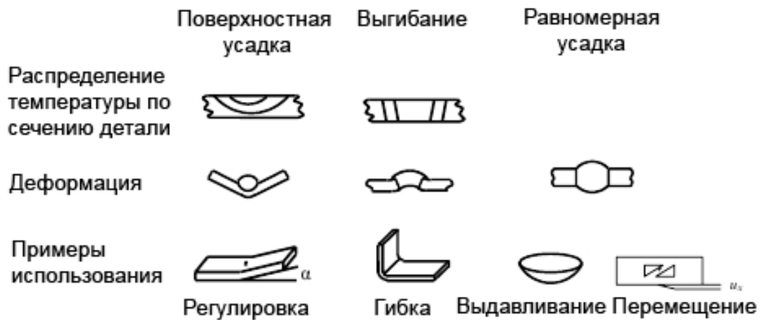
Рис. 7.1 Основные виды деформаций, которые могут быть получены при лазерном нагреве
