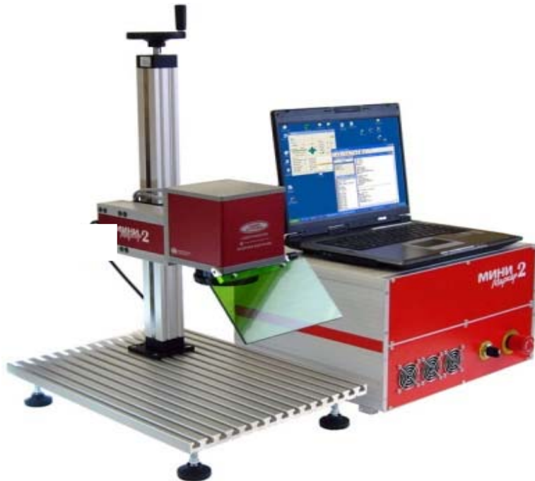
Рис. А2 Общий вид установки «Минимаркер-У»
