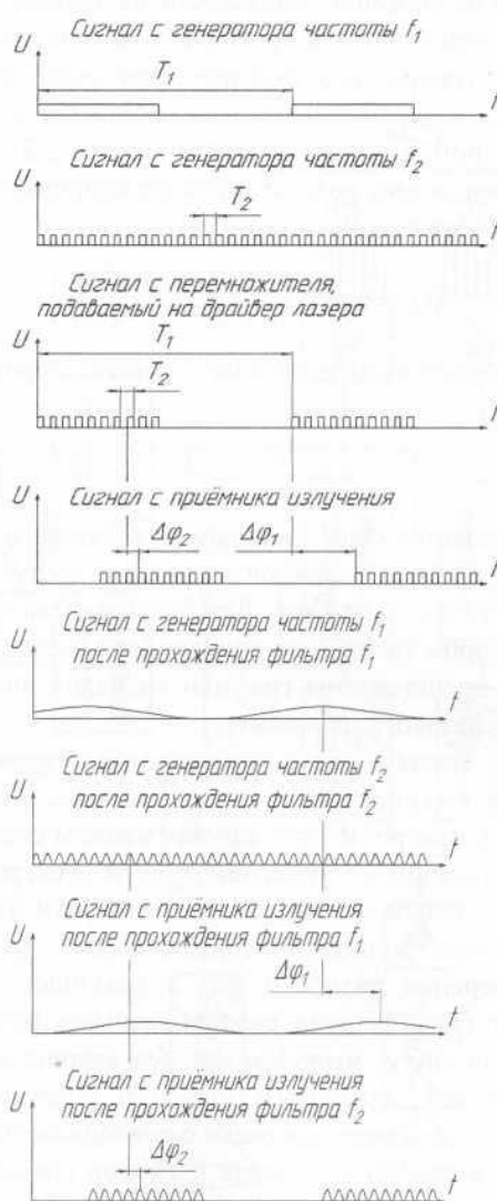
Рисунок 29 – Графики сигналов лазерного фазового дальномера
