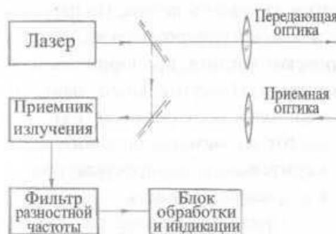
Рисунок 32 – Схема доплеровского измерителя скорости
