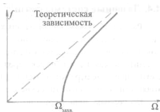
Рисунок 24 – Зависимость частоты биений от скорости вращения контура
