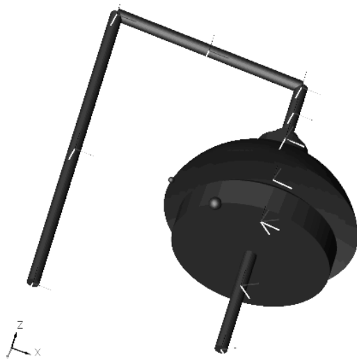
Рис. 6.5. а), б) – Анимированная модель SimMechanics шпиндельного блока шлифовально-полировального станка радиус кривизны инструмента R > 0
