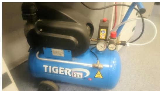
Рисунок 4.11 – Компрессор для подачи сжатого воздуха в систему BIostat® A
