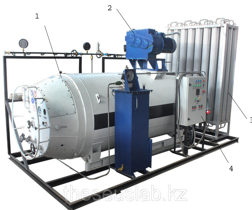
Рис. 4.15 Газификационная установка с погружным насосом для криопродукта на базе ЦТК-1,0/0,25:
