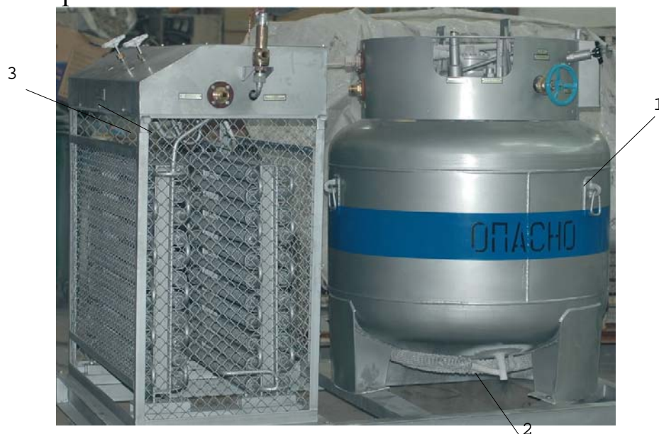
Рис. 4.12 Внешний вид «холодного» газификатора на базе цистерны криогенной транспортной ЦТК-0,5/0,25
