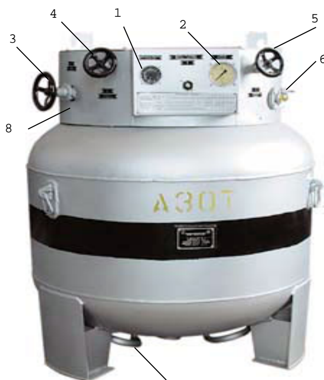
Рис. 4.8 Внешний цистерны транспортной криогенной ЦТК–0,5/0,25: 1–указатель уровня, 2–манометр, 3– вентиль «Газосброс», 4 – «Жидкость в испаритель», 5– вентиль «Наполнение–выдача», 6– штуцер «Наполнение–выдача» D_y=16 мм, 7– испаритель жидкости, 8 –арматурный ящик
