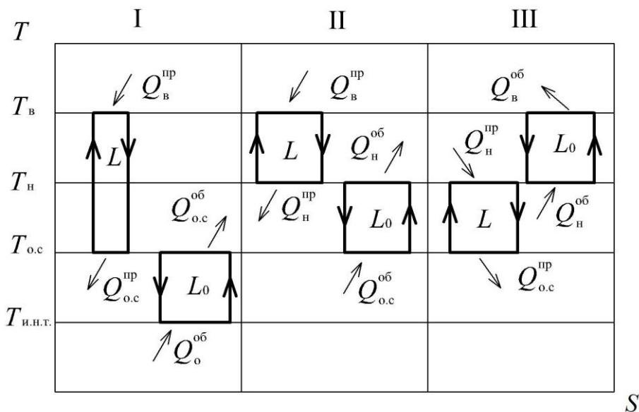
Рис. 1. Системы прямых и обратных термодинамических циклов:
