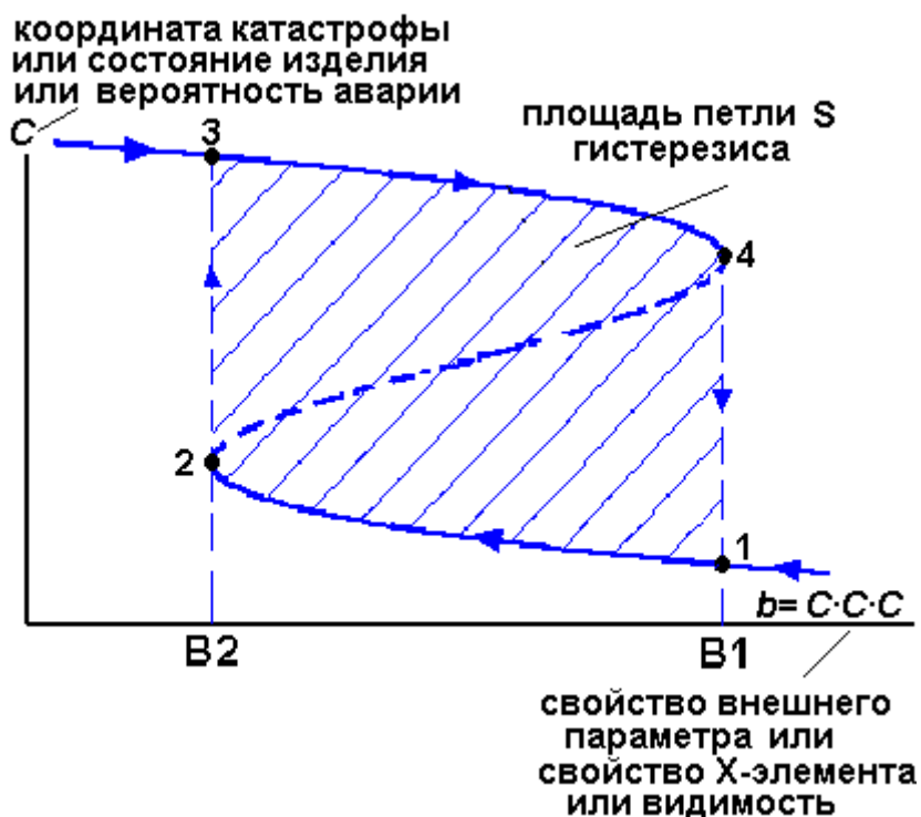
Рисунок 3.13. Нежелательный эффект как площадь петли гистерезиса бифуркационной кривой
