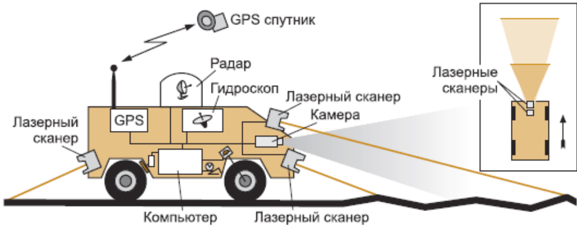
Рисунок 1.1 — Схема конструкции автономного мобильного робота
