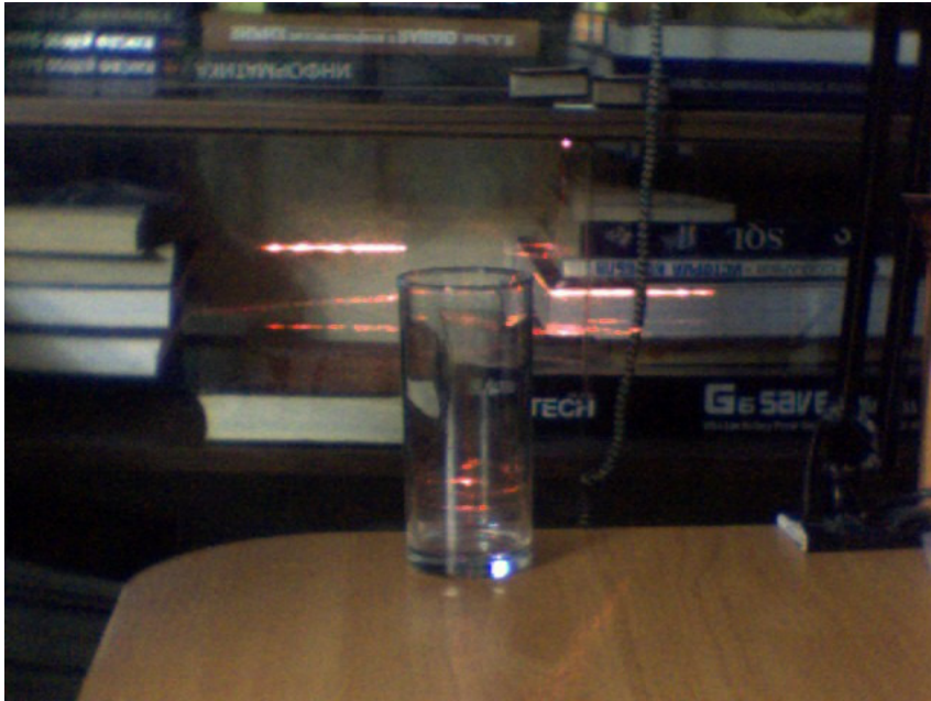
Рисунок 4.22 — Изображение стакана, световой луч расщепляется и почти не отражается от поверхности
