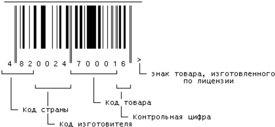
Рисунок 2.34 — Кодировка EAN-13, применяемая в торговле
