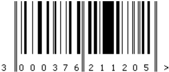
Рисунок 2.33 — Пример одномерного штрих-кода в кодировке EAN-13
