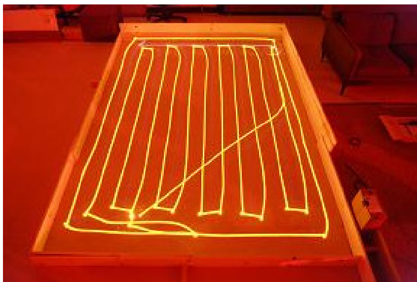
Рисунок 1.8 — Траектория движения робота Neato
