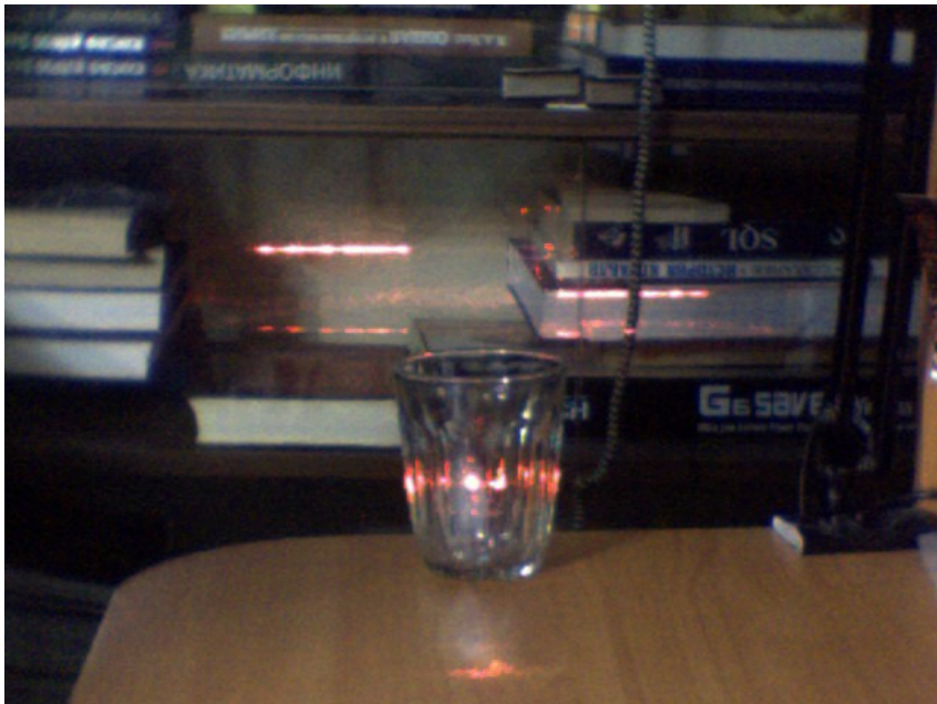
Рисунок 4.23 — Изображение стакана сложной структуры, световой луч расщепляется и, за счет внутренних отражений, виден как несколько точек
